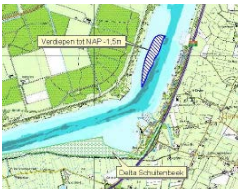
Figuur 2.2 Reeds gerealiseerde verdieping Nulder nauw
